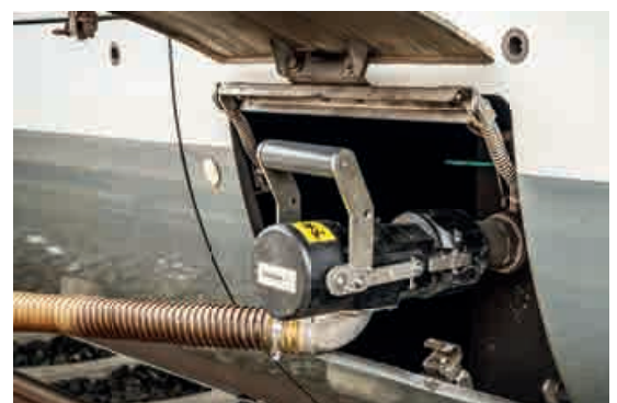
Die tropffreie Absaugkupplung im Einsatz an einem ICE
