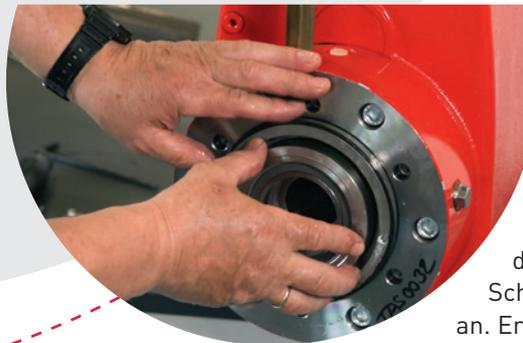
Nun zieht ihr die zwei weiteren O-Ringe auf die Cartridge selbst auf und setzt die neue Dichtung ein. Um sie in ihren Sitz zu drücken, setzt ihr den Antriebsadapter auf die Cartridge-Dichtung und drückt diese dann mit zwei Schrauben gleichmäßig wieder an. Erst dann setzt ihr die übrigen vier Schrauben ein und zieht sie fest.
