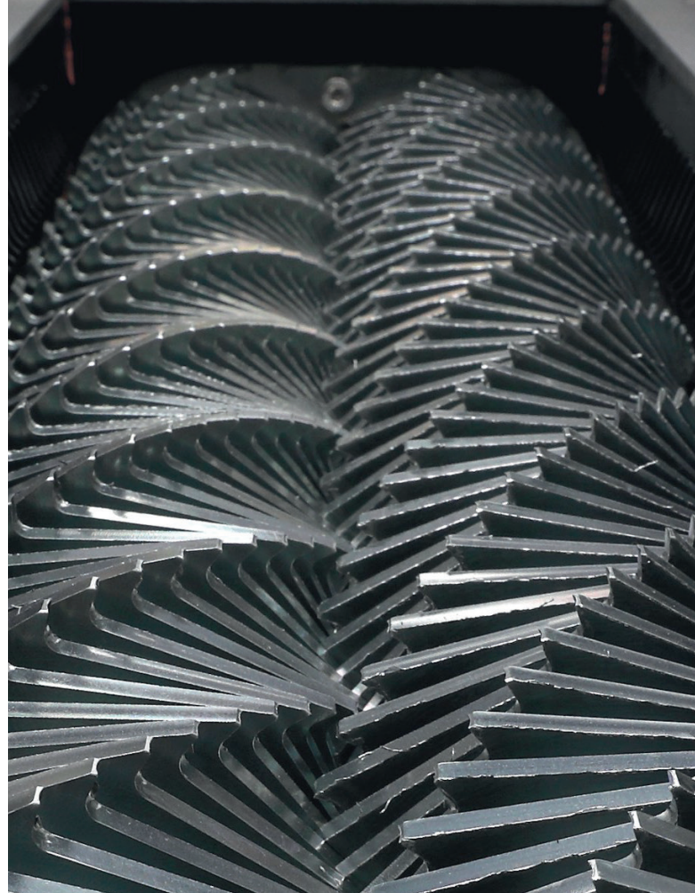
Monolitik yekpare Ripper bıçakları son derece sağlamdır ve bakımı özellikle kolaydır.
