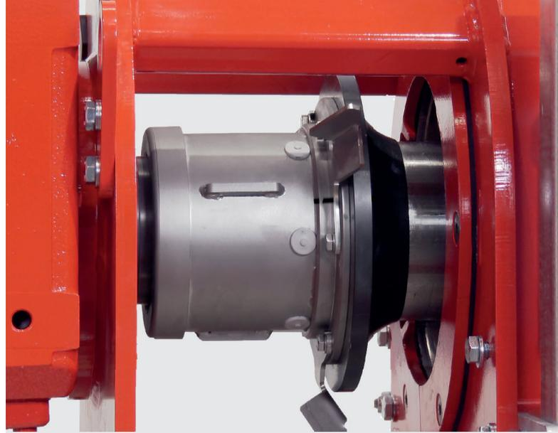
Ajuste hidráulico VarioAdjust: mediante una bomba manual se ajusta la presión hidráulica en el ajuste, con lo que la presión de contacto se adapta al medio.
