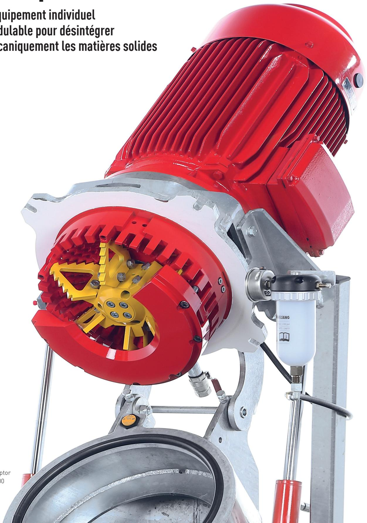
Optimiser la désintégration du substrat est essentiel dans la production de biogaz. C'est pourquoi Vogelsang propose une alternative mécanique flexible, à la désintégration de ces substrats: le DisRuptor. La réduction de la taille des particules et le défibrage simultané améliorent l'utilisation de la matière solide et permet aux bactéries d'atteindre plus facilement les nutriments Accélérant la conversion de la matière et d'augmenter le rendement en gaz.
