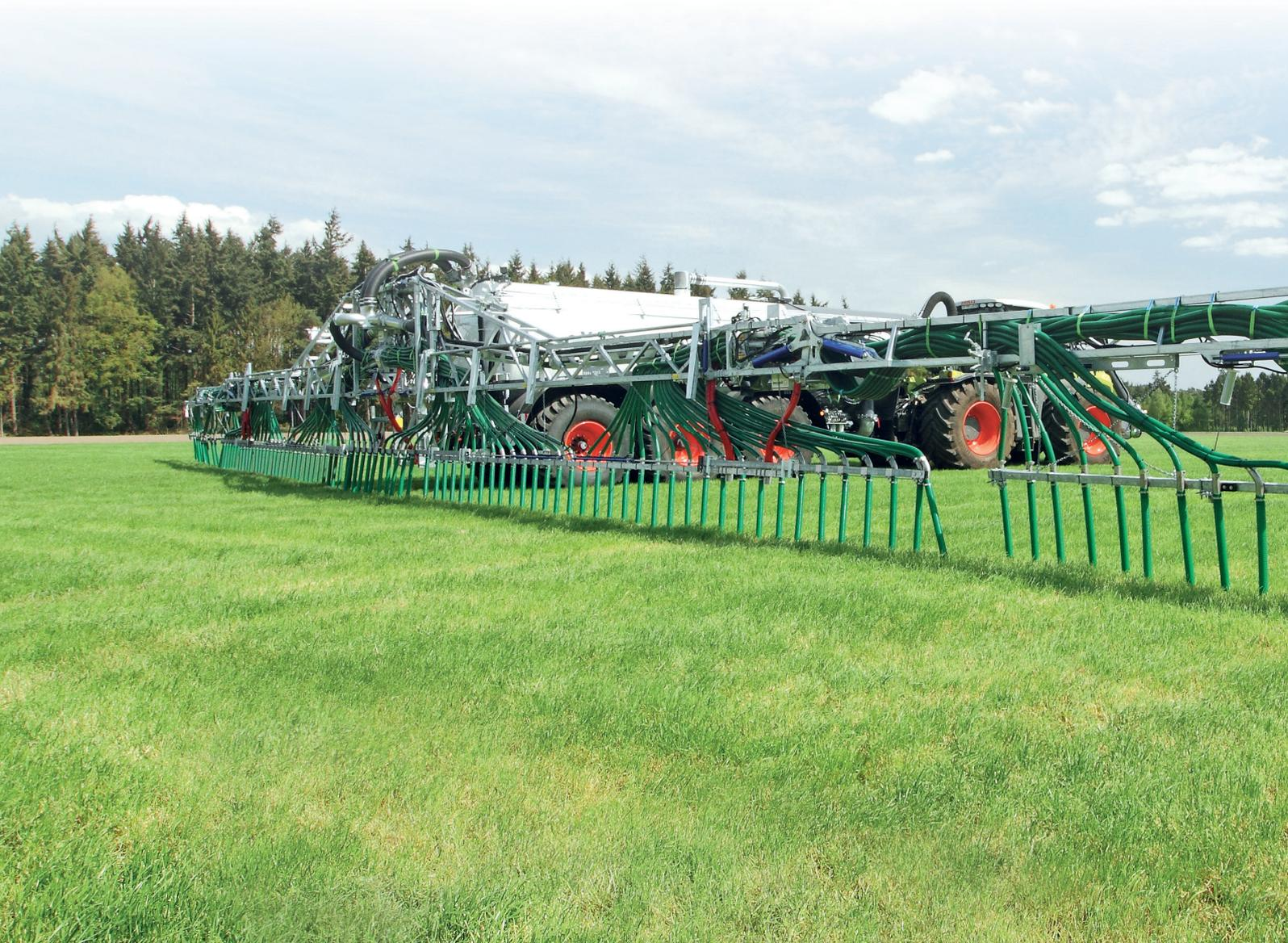
SwingMax36 es una nueva dimensión. Ahora es posible aplicar purín de manera uniforme con un ancho de trabajo de 36 metros, utilizando las roderas ya existentes y reduciendo al mínimo los costes, el tiempo y los desplazamientos por el campo.
