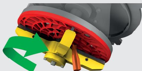
Grâce à la fonction d'inversion automatique, le système détecte tout blocage dans la tête de coupe et inverse alors le sens de rotation du rotor. Ce processus se répète jusqu'au broyage des matières bloquées.
