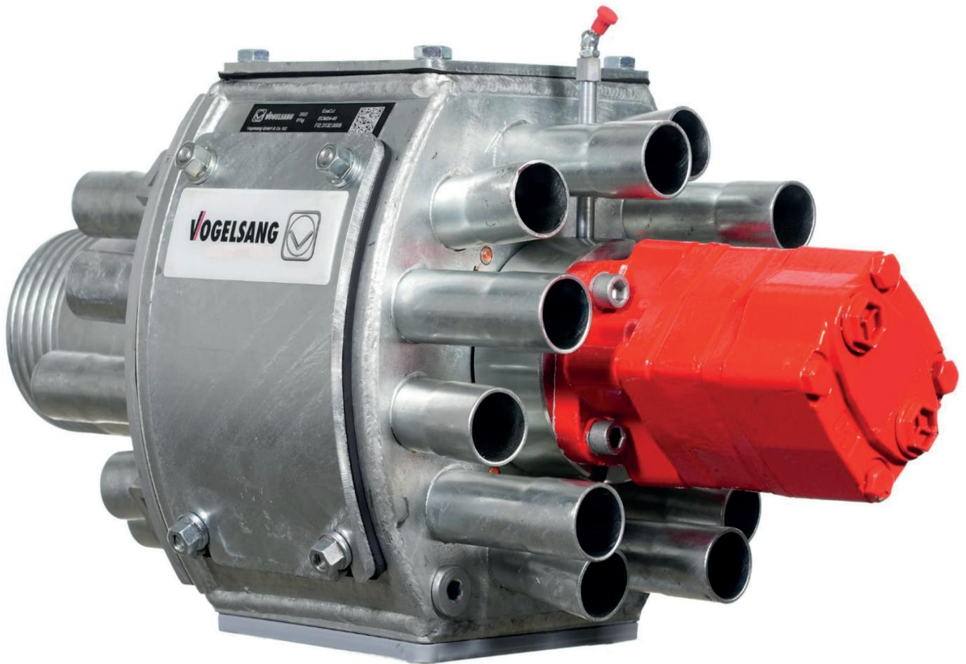
Bisher waren sämtliche Exaktverteiler auf dem Markt mit Belüftungsschläuchen und einer Luftnachsaugung versehen, um einen gleichmäßigen Abfluss der Gülle in die Ablaufschläuche zu gewährleisten.
