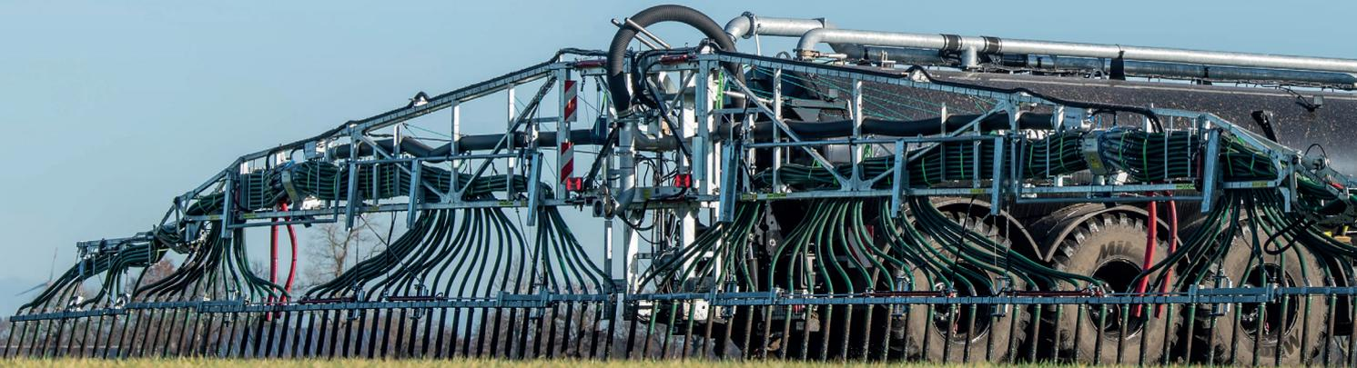
SwingMax ist die optimale Lösung für die Gülleausbringung mit hohen Arbeitsbreiten. Ausstattungsmöglichkeiten wie TopSwing, DoubleFold, TeleShift und Comfort Flow Control garantieren höchstmögliche Einsatzflexibilität. Die spezielle räumliche Ausführung als Doppelrahmen ist höchsten dynamischen Belastungen gewachsen und sichert damit den störungsfreien und wirtschaftlichen Betrieb bei gleichzeitiger Gewichtsoptimierung.
