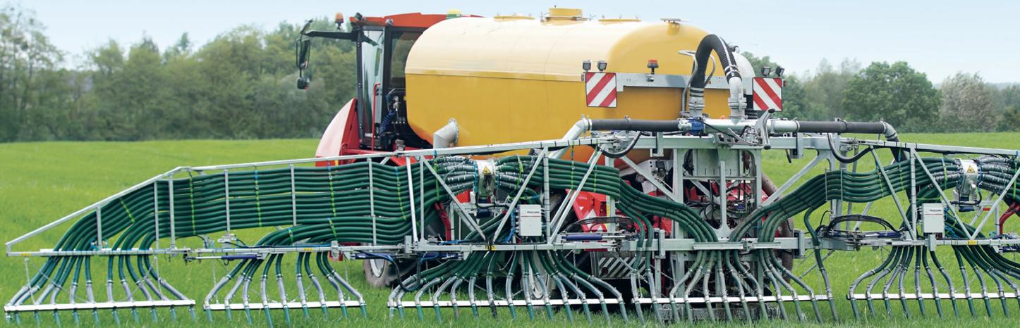
Compax-Schleppslauchgestänge und Selbstfahrer bilden eine schlagkräftige Einheit für die bodenschonende Gülleausbringung. Die Klapptechnik des Compax wurde auf die Ausbringung mit einem Selbstfahrer zugeschnitten: Compax klappt sich komplett hinter dem Fahrzeug zusammen, sodass weder die Sicht des Fahrers eingeschränkt noch die Breite des Fahrzeugs vergrößert wird.
